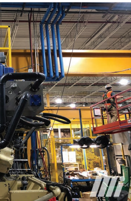
Figures 1 et 2 – Cette conversion concerne un collecteur d'injection sur une presse à injection. En raison de l'obsolescence de la machine, les pièces détachées et l'assistance technique de l'équipementier sont difficiles à obtenir. La conversion repose principalement sur l'utilisation de composants standardisés avec une solution de collecteur personnalisée plus simple conçue par Motion, ce qui permet à l'utilisateur final de réduire les coûts. Images fournies par Motion.
